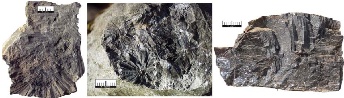
11. ábra – A radiaxiális kalcit kristályszerkezet megjelenése a törési felületeken. A jobb oldali képen a sugaras kristályokra merőleges, gömbhéjas elválás figyelhető meg. (A lépték 1 cm-es)
