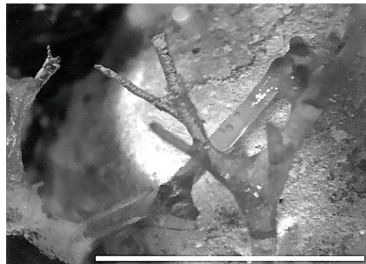
12. ábra. Entobia geometrica feltárószálak epoxigyanta öntvénye.
